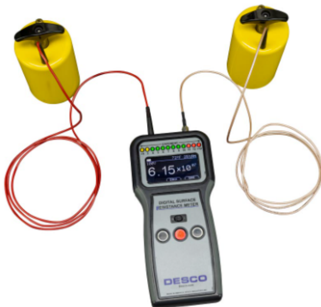
ANSI/ESD-S7.1 接地間漏洩抵抗値測定方法
